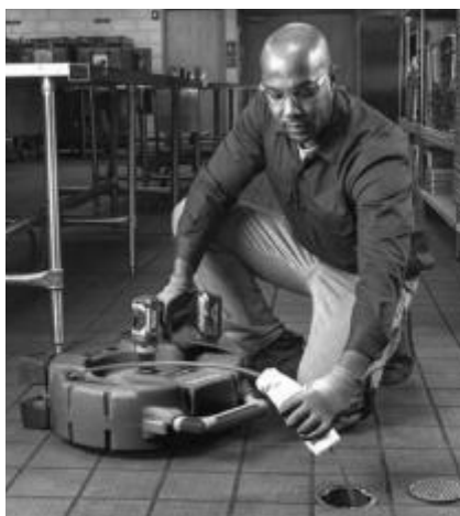
Obrázek 13 – Aplikace maziva na kabelové pouzdro
