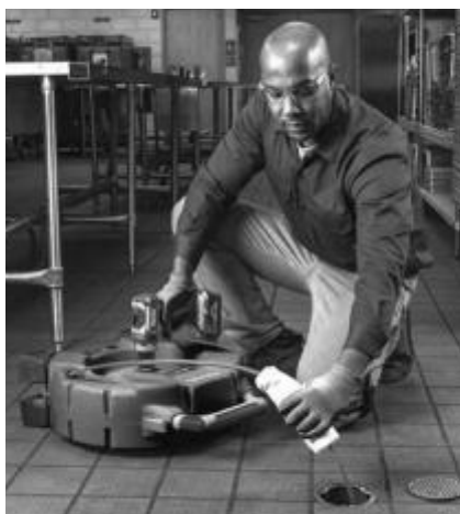
Slika 13 - Nanašanje maziva na ovoj kabla
