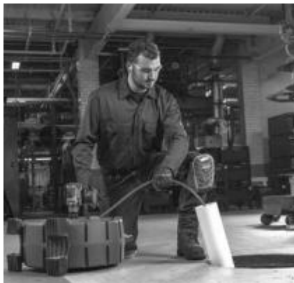
Kuva 5 – Esimerkki viemäriaukon pidentämisestä 3' päähän koneen jousiaukko
