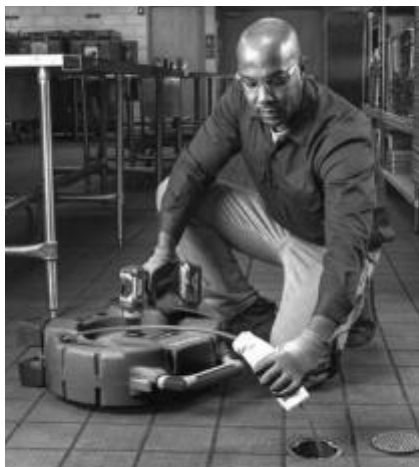
Εικόνα 13 – Εφαρμογή λιπαντικού στο περίβλημα σπιράλ
