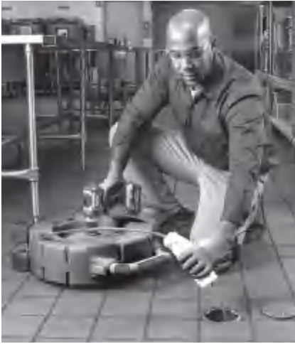
그림 13 - 윤활유를 케이블 피복에 도포
