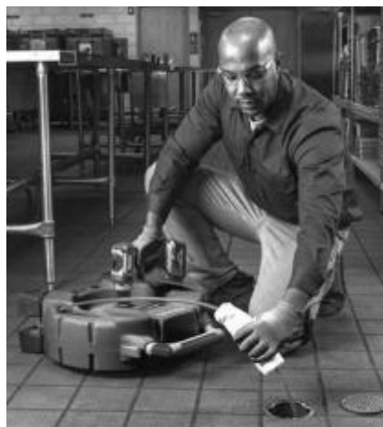
Figuur 13 – Smeermiddel aanbrengen op de veermantel
