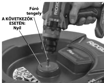
4. Ábra – A fúrógép csatlakoztatása a fúrotengelyhez
