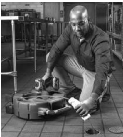
Figura 13 – Aplicar lubrificante ao revestimento do cabo
