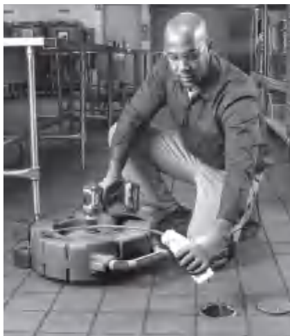
图 13 – 向钢索护套管涂抹润滑剂
