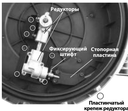
Рис. 14 - Корпус машины для прочистки канализации открыт
