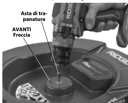
Figure 4 – Collegamento del trapano all'asta di trapanatura
