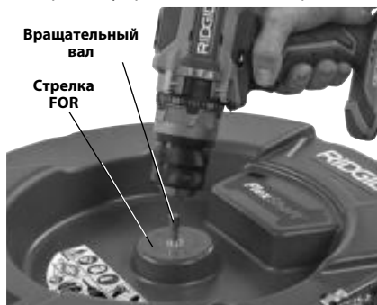
Рис. 4 - Крепление дрели к вращательному валу
