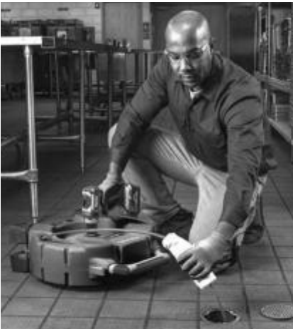
Obrázok 13 – Nanášanie maziva na plášť kábla
