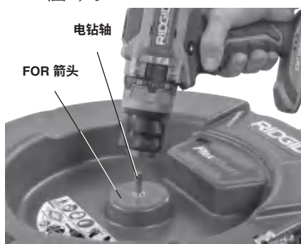
图4 – 将电钻连接到电钻轴
