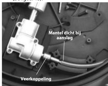
Figuur 15 – Veereenheid vervangen
