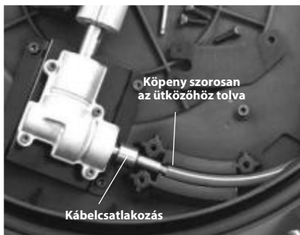
15. Ábra – A kábelszerelvény cseréje
