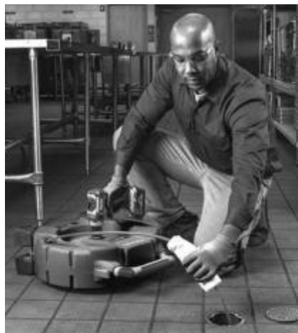
Rysunek 13 – Nakładanie środka smarnego na osłonę wałka giętkiego
