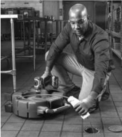
Figur 13 – Påføring af smøremiddel på spiralkappen
