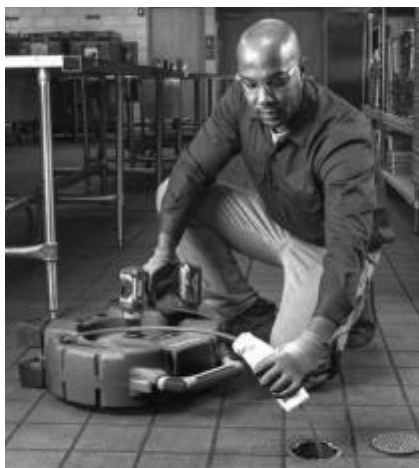
Abbildung 13 – Auftragen von Schmiermittel auf die Spiraleummantelung
