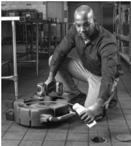
13. Ábra – Kenőanyag felvitele a kábelköpenyre
