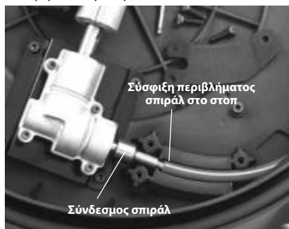
Εικόνα 15 – Αλλαγή του συγκροτήματος σπирάλ
