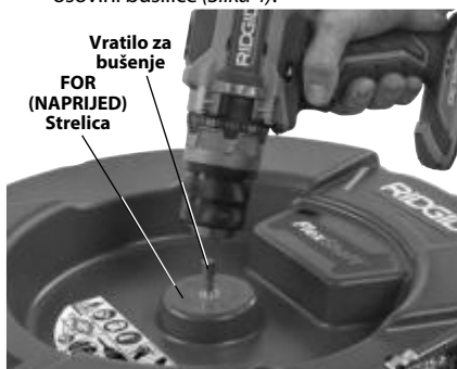
Slika 4 – Postavljanje bušilice na vratilo za bušenje
