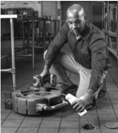
Figura 13 – Applicazioni di lubrificante nella Guaina del cavo
