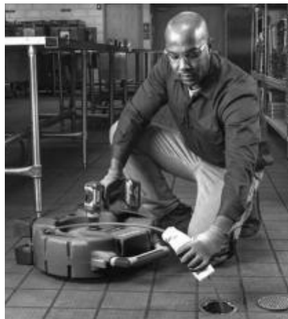
Рис. 13 - Нанесение смазки на оболочку троса
