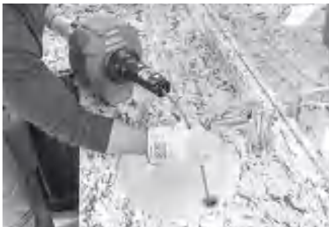
Slika 14 – Sajla sa ručnim uvlačenjem
