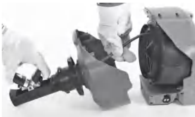
Figur 18 – Mating av kabel inn i trommel
