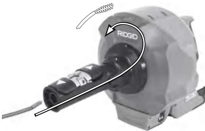
Εικόνα 21 – Τοποθέτηση σπιδάλ χωρίς αλλαγή του εσωτερικού τύμπανου
