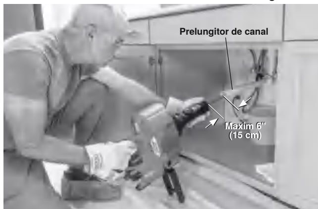
Figura 6 – Exemplu de scurgere prelungită până la 6" (15 cm) de unitatea AUTOFEED
