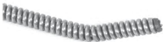
19. ábra - Megtörés a kábelvégnél
