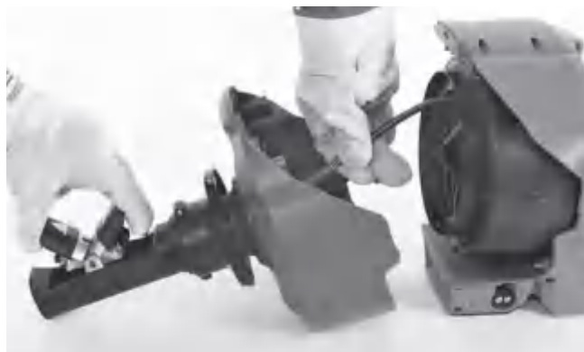
Figura 18 – Alimentación del cable dentro del tambor
