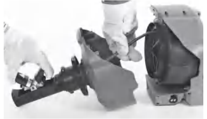
Şekil 18 – Kablonun Tambura Beslenmesi
