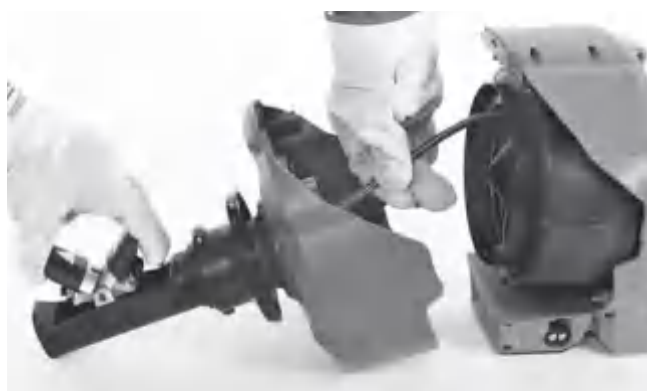
Εικόνα 18 - Εισαγωγή του σπιράλ στο τύμπανο
