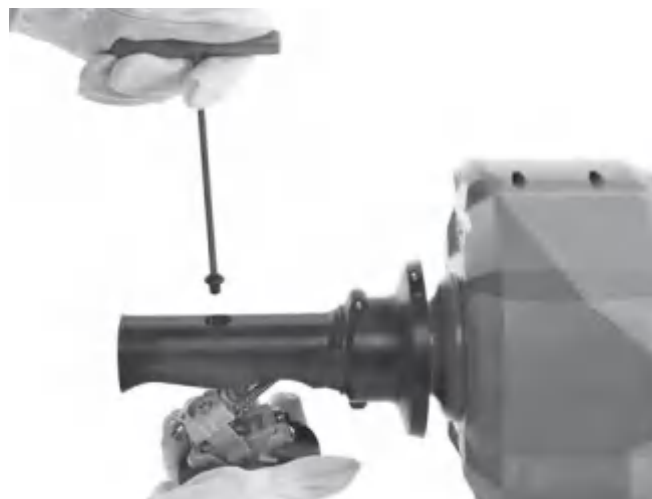
Рисунок 16А – Снятие механизма автоподдачи
