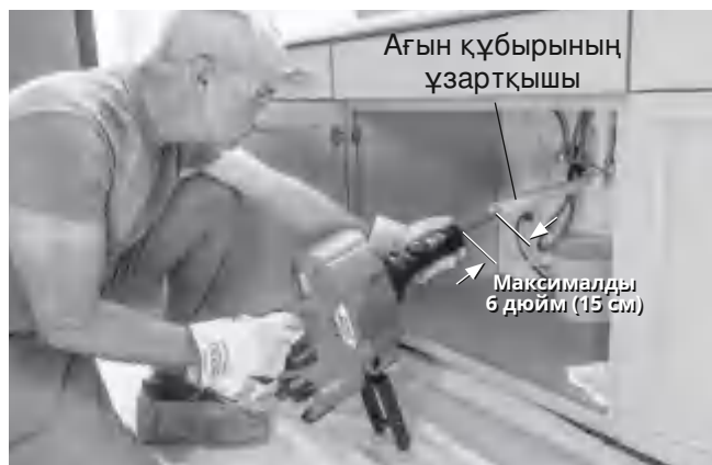
6-сурет – Ағын құбырын AUTOFEED бөлігінен 6 дюйм (15 см) шегінде созу үлгісі.
