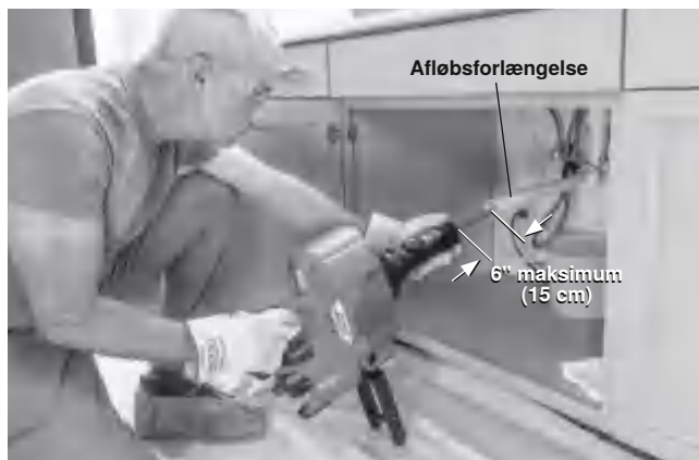
Figur 6 – Eksempel på forlængelse af afløbet til inden for en afstand af 6" (15cm) fra AUTOFEED-enheden
