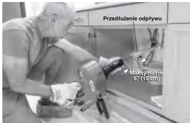
Rysunek 6 – Przykład przedłużania odpływu, aby osiągnąć odległość 6" (15 cm) dla jednostki AUTOFEED.
