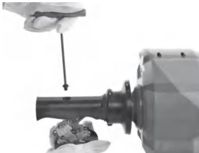
Rysunek 16A – wymontowanie mechanizmu AUTOFEED
