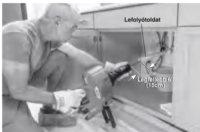
6. ábra - Példa a lefolyó torkolatának toldatára 6" (15 cm) távolságnál közelebbre az AUTOFEED egységtől
