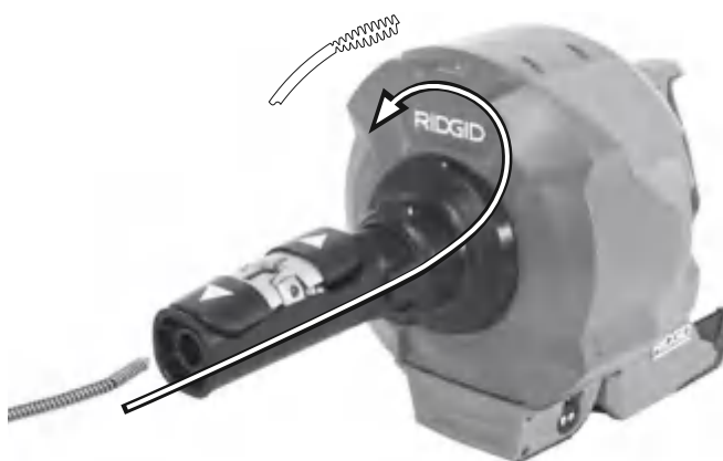
Figura 21 – Încărcarea cablului fără schimbarea tamburului interior
