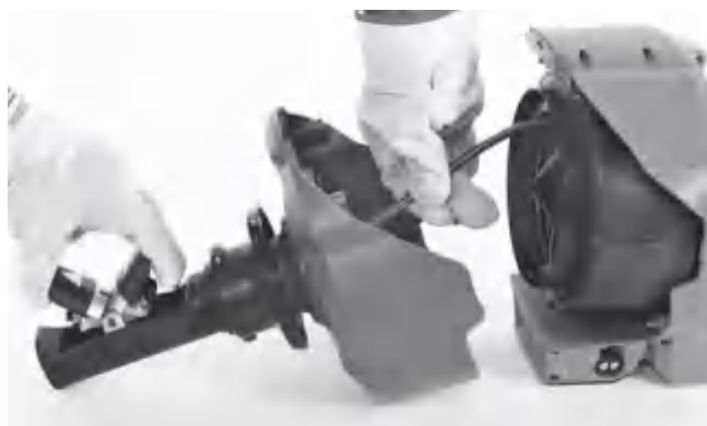
Рисунок 18 – Подача спирали в барабан
