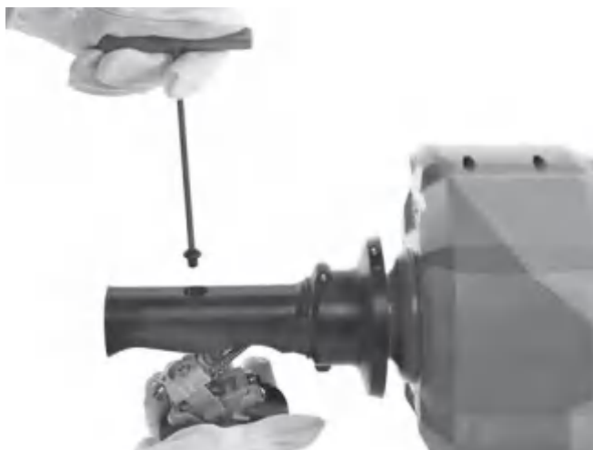
Figura 16A – Îndepărtarea mecanismului AUTOFEED
