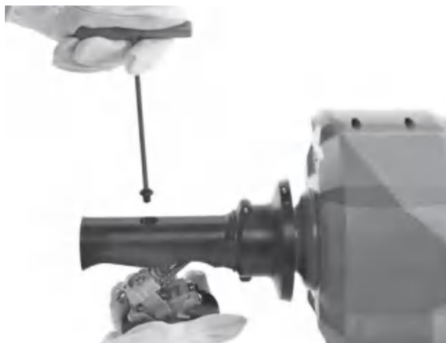
Slika 16A – Uklanjanje mehanizma AUTOFEED
