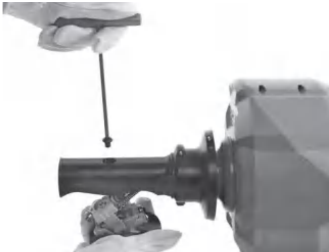
Abbildung 16A - Ausbau des AUTOFEED Mechanismus
