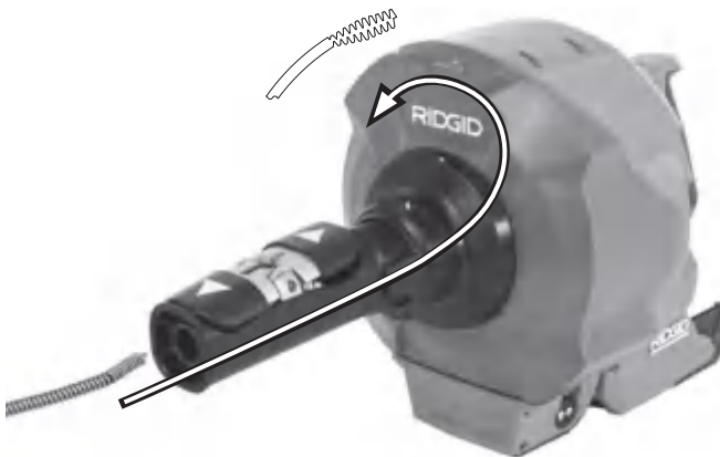
图 21 – 在不更换内鼓轮的情况下装载钢索
