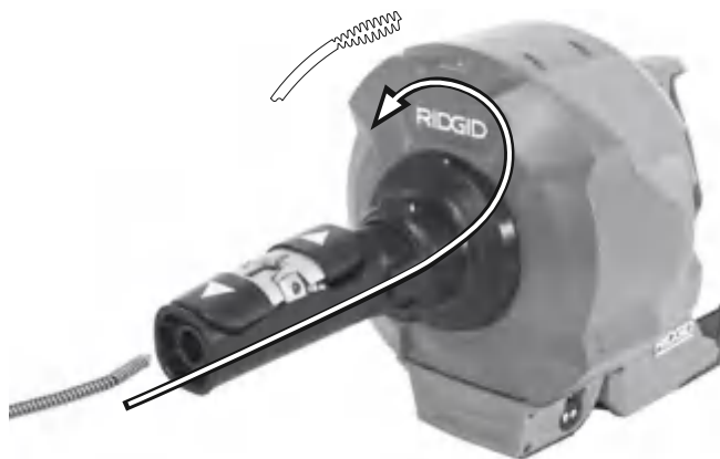
21-сурет – Ішкі барабанды ауыстырмай кабельді салу
