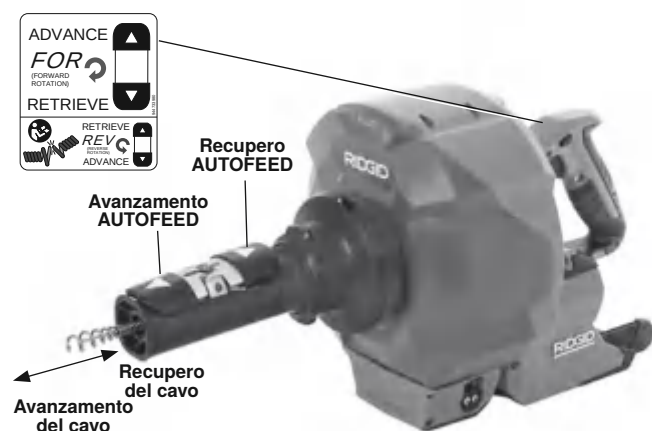
Figura 11 - Comandi dell'unità AUTOFEED
