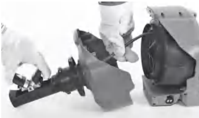
Obrázek 18 – Zavádění kabelu do bubnu
