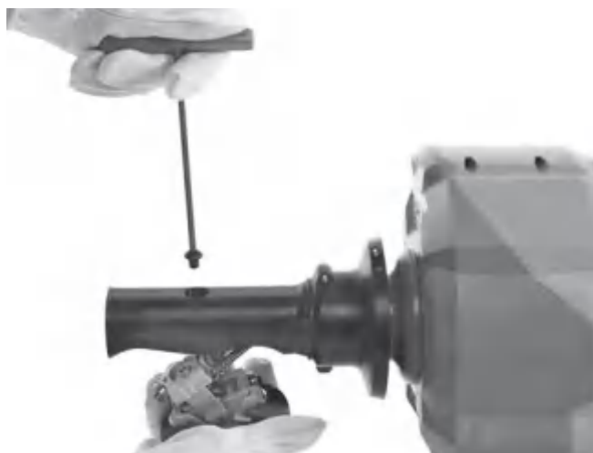
Фигура 16А – Демонтиране на механизма AUTOFEED
