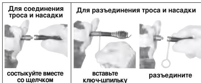
Рисунок 7 – Подсоединение и отсоединение насадок
