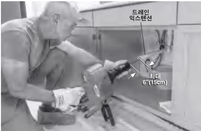
그림 6 – AUTOFEED 장치에서 6\"(15cm) 이내로 드레인을 확장한 예
