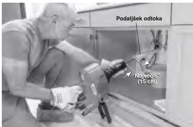
Slika 6 – Primer podaljšanja odtoka do 6" (15 cm) enote AUTOFEED
