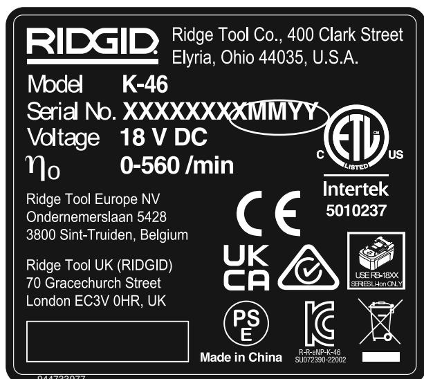
Obrázok 3 – Výrobné číslo stroja – posledné 4 číslice výrobného čísla udávajú mesiac a rok výroby (MM-RR).
