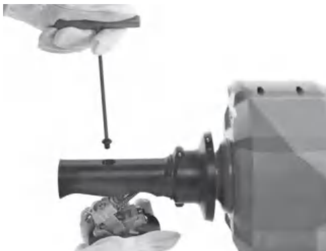
Figura 16A – Remoção do mecanismo AUTOFEED
