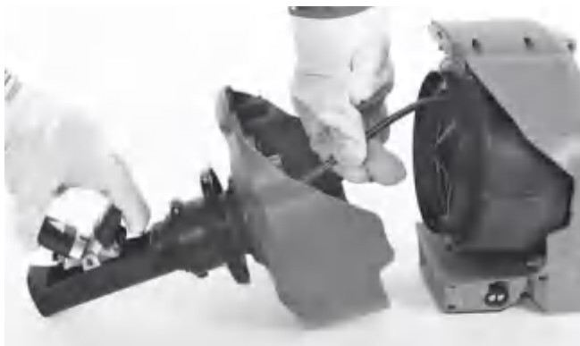
Slika 18 – Uvlačenje sajle u bubanj
