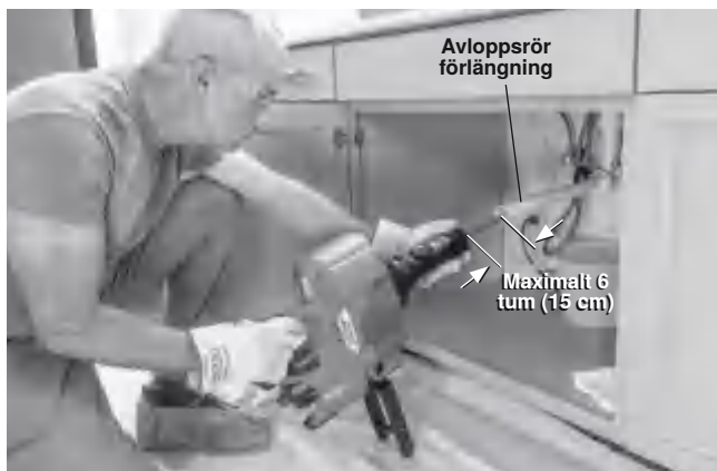
Figur 6 – Exempel på förlängning av avlopp till 6 tum (15 cm) från AUTOFEED-enheten.
