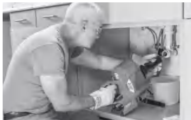
Figura 13 – Avansarea cablului cu unitatea AUTOFEED
