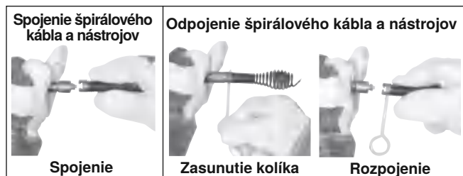
Obrázok 7 – Pripájanie a odpájanie nástrojov
