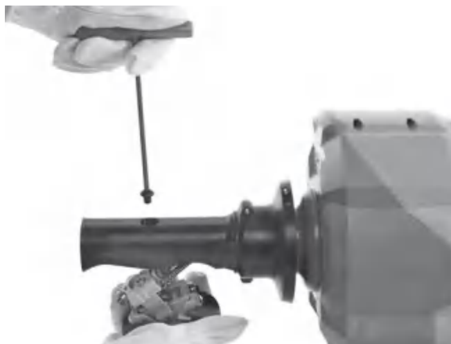
Figur 16A – Borttagning av AUTOFEED-mekanismen
