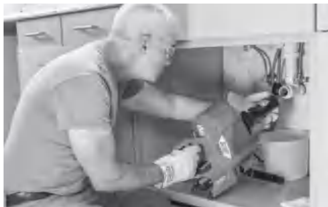
Figur 13 – Mata spiralen med AUTOFEED-enheten
