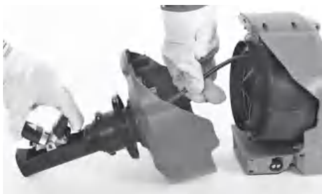
18. ábra - Kábel bevezetése a dobba
