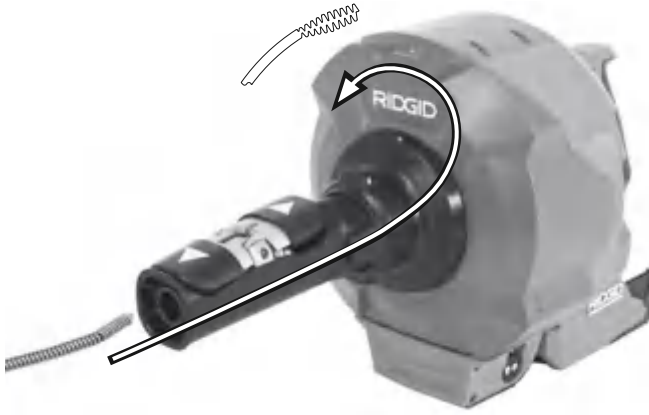
Şekil 21 – İç Makarayı Değiştirmeden Spiral Yüklenmesi
