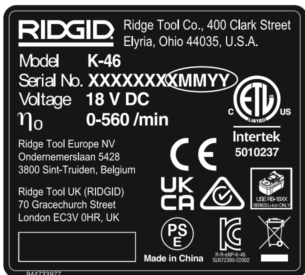
Obrázek 3 – Sériové číslo přístroje - poslední 4 číslice sériového čísla udávají měsíc a rok výroby (MMRR).
