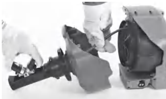
Figur 18 – Indføring af spiral i tromle
