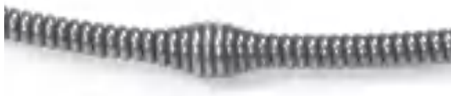
Figur 15 – C-13-IC SB spiral med spiraländesindikator (Speedbump) är ca 5 fot (1,5 m) från spiralens bakre ände
