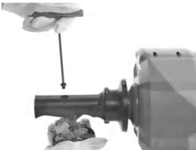
Figura 16A - Rimozione del meccanismo AUTOFEED
