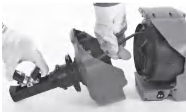
Figure 18 – Enroulage du câble dans le tambour
