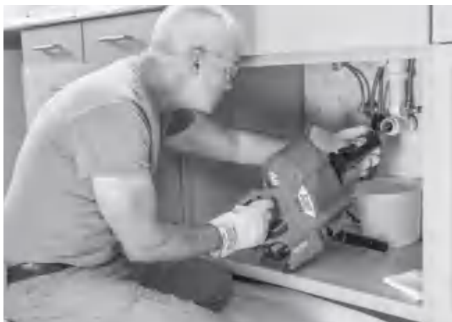
13-сурет – Кабельді AUTOFEED бөлігі арқылы өткізу
