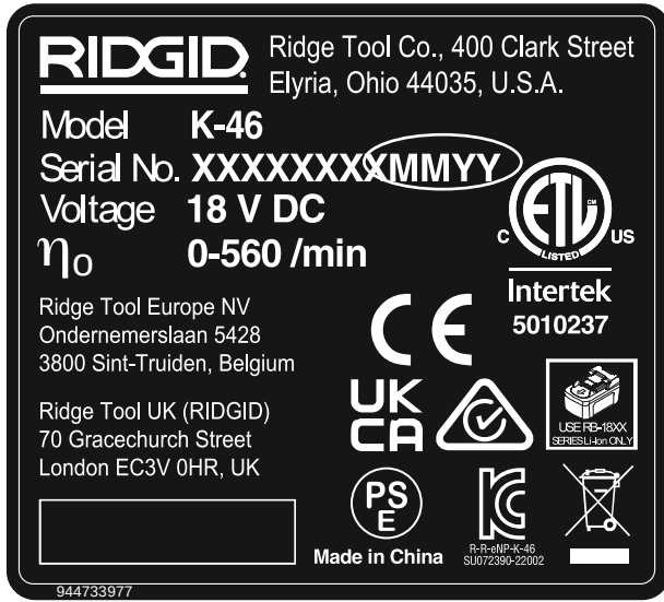
Şekil 3 – Makine Seri Numarası - Makine seri numarasının son dört hanesi üretim ayını ve yılını gösterir (AAYY).
