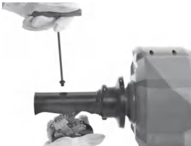
Obrázek 16A – Demontáž mechanismu AUTOPOSUVU
