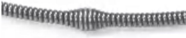
Figur 15 – C-13-IC SB-kabel med Speedbump-indikator for kabelende er omtrent 5' (1,5 m) fra kabelens bakre ende
