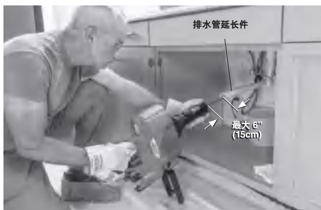
图 6 – 示例：将排水管延伸至离 AUTOFEED 自动进给单元 6" (15cm) 以内
