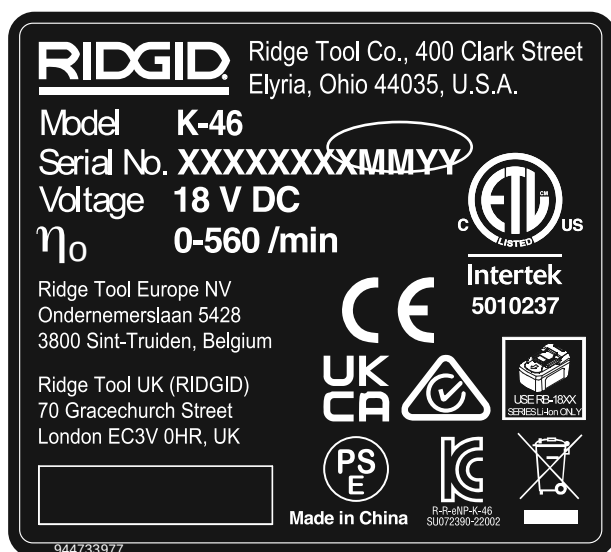
Figur 3 – Maskinens serienummer – De sista fyra siffrorna i serienumret visar tillverkningsmånad och -år (MMÅÅ).
