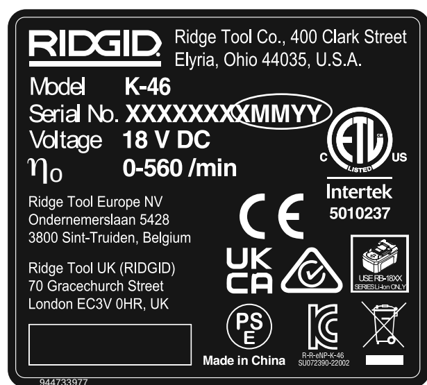
Εικόνα 3 – Αριθμός σειράς του μηχανήματος - Τα τελευταία 4 ψηφία του αριθμού σειράς υποδεικνύουν τον μήνα και το έτος κατασκευής (MMEE).
