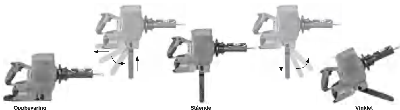
Figur 8 – Justering av støtte
