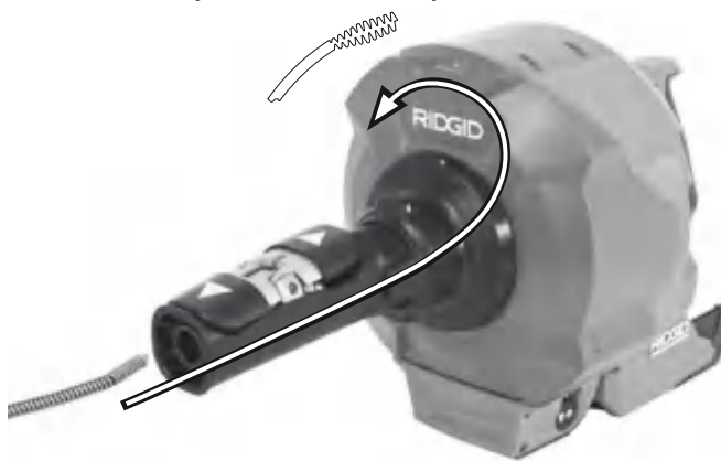
Slika 21 – Uvlačenje sajle bez zamjene unutarnjeg bubnja
